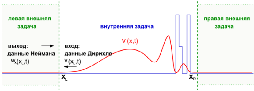
Рис. 1.5. Основная идея построения ПГУ: разделение пространственной области на внутренние и внешние задачи. (Рис.1 в [65])
